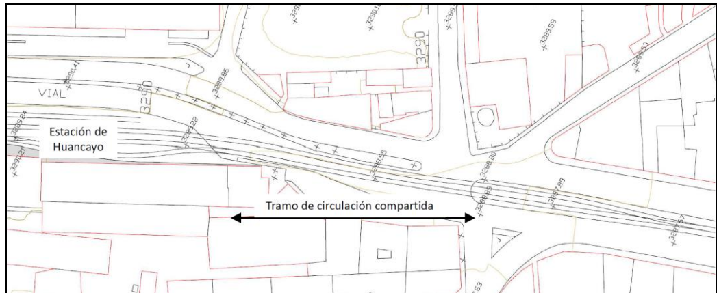
Anexo 6 - Figura N° 14: Tramo de circulación compartida la salida de la estación de Huancayo
