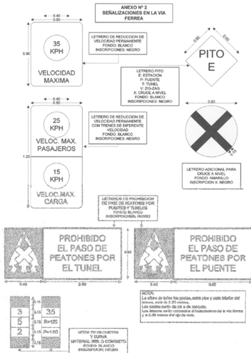
Anexo 6 - Figura N° 17: Señalizaciones en la Vía Férrea
