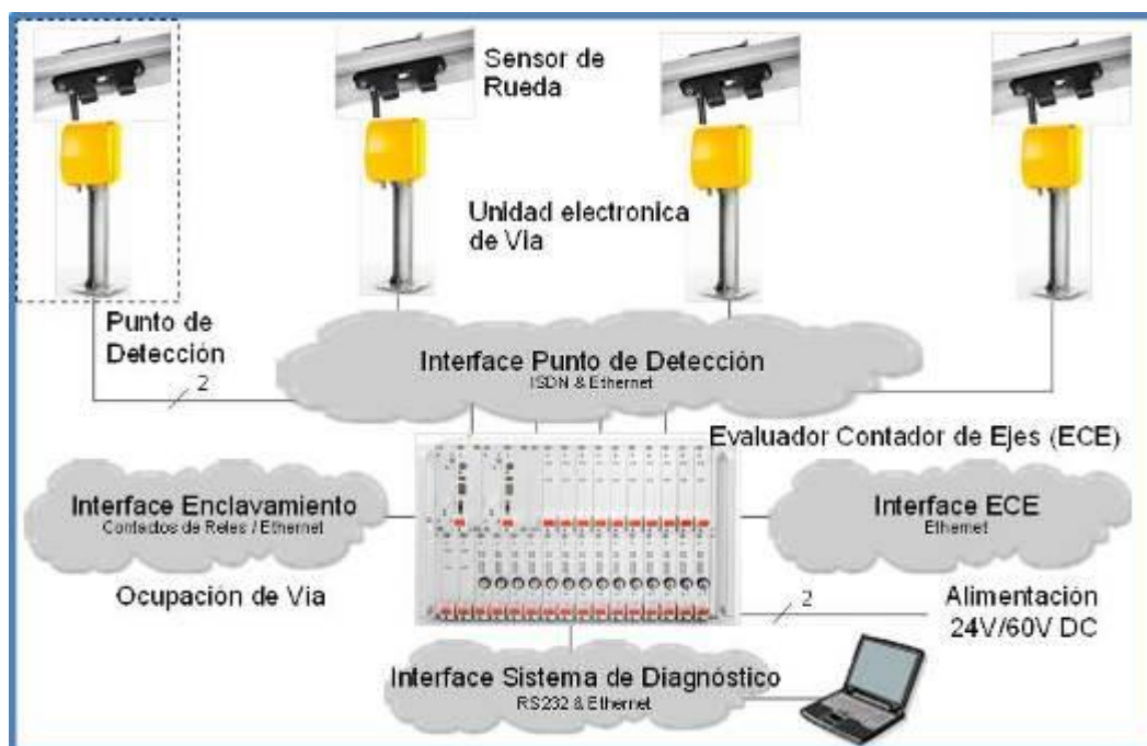
Anexo 6 - Figura N° 23: Propuesta referencial de Componentes del Sistema Contador de Ejes
