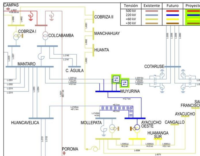
Figura N° 1: Esquema unifilar de los Equipos FACTS Serie de LT 220 kV Muyurina-Cotaruse en SE Muyurina.
