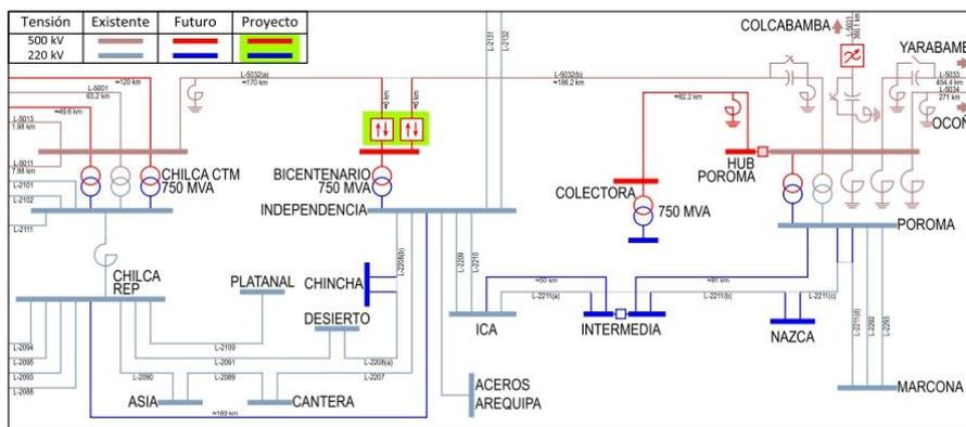
Figura N° **¡Error! No hay texto con el estilo especificado en el documento.**: Esquema unifilar de los Equipos FACTS Serie de LLTT 500 kV Bicentenario-Chilca CTM y Bicentenario-Poroma en SE Bicentenario
