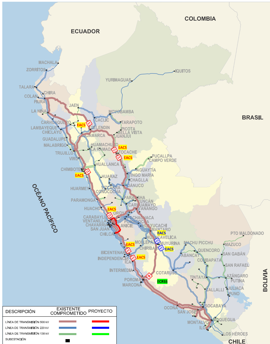
Figura 3.1 Mapa del SEIN con la expansión del sistema de transmisión del SEIN y equipos FACTS Serie, año 2028.
