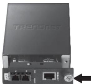
3. Inserte el convertidor de medios en una ranura disponible y apriete el tornillo de ajuste manual.
