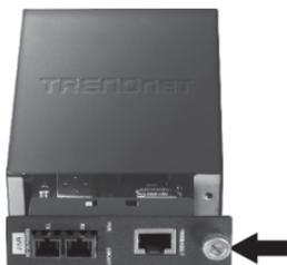
3. Inserte el convertidor de medios en una ranura disponible y apriete el tornillo de ajuste manual.
