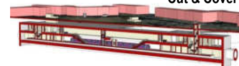
Estación excavada en Cut & Cover
