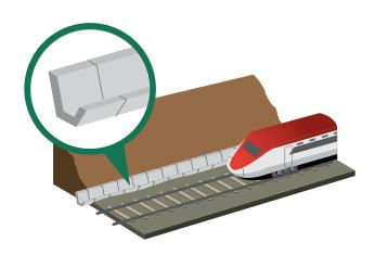
Construcción del sistema de drenaje longitudinal (cunetas), y mejoramiento del sistema de drenaje transversal, a lo largo de la vía férrea
