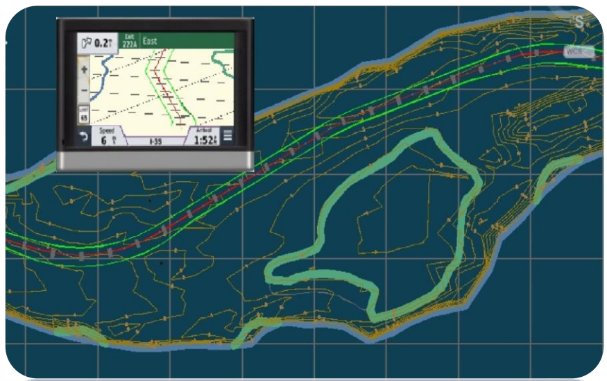
Archivo con la posición actualizada del eje y veriles del canal cargados en un navegador o una notebook con GPS.
