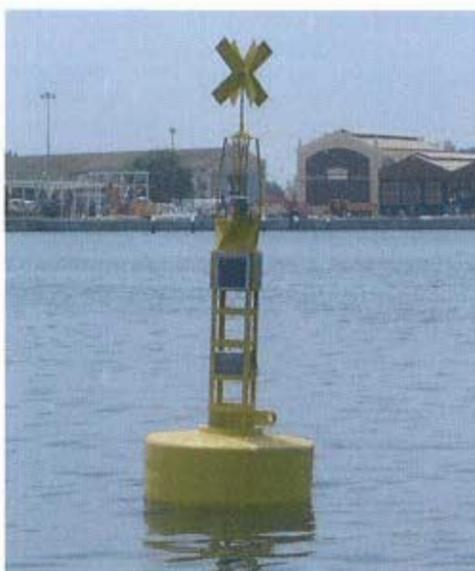
**Figura 56. Marca especial flotante con marca de tope en forma de aspa**
