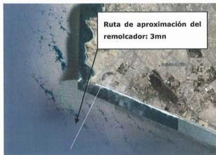
Figura 57. Ruta de aproximación del remolcador a la obra durante el traslado de las conducciones
